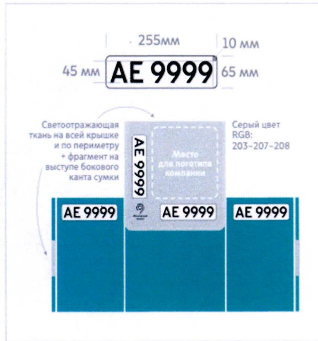
Рисунок 1 – внешний вид сумки курьера, с указанием мест обязательного размещения идентификационных номеров
